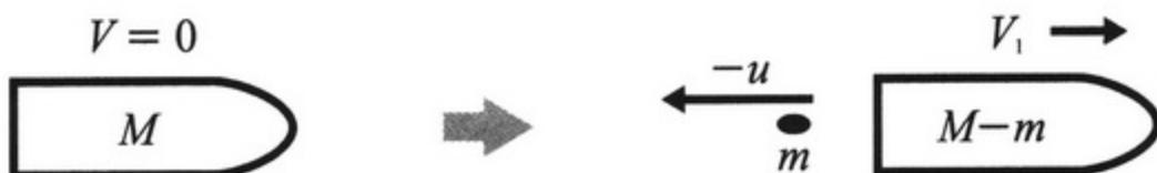
首先，在宇宙中静止的火箭，以速度  $-u$  ( $u > 0$ ) 放出质量为  $m$  的小物体。小物体与火箭的质量和为  $M$ ，放出后火箭的速度以  $V_1$  表示，根据动量守恒定律有：
