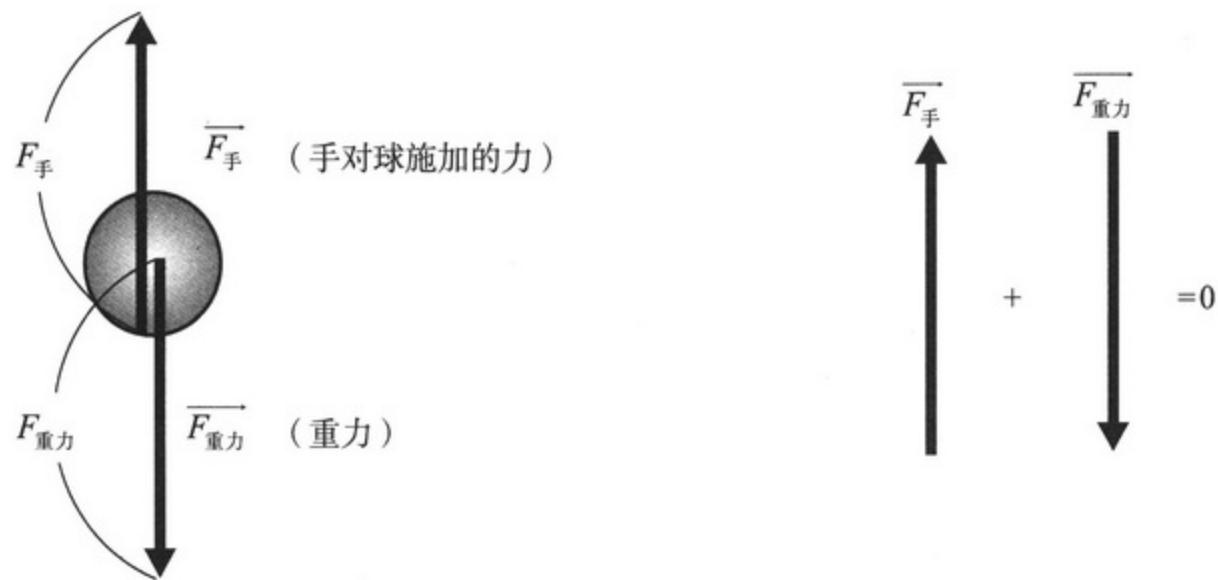
来详细研究一下放在手掌上的球的力的平衡。手对球施加的力表示为  $\vec{F}_{\text{手}}$ ，球的重力表示为  $\vec{F}_{\text{重力}}$ ，那么使球运动的合力  $\vec{F}_{\text{合力}}$  为
