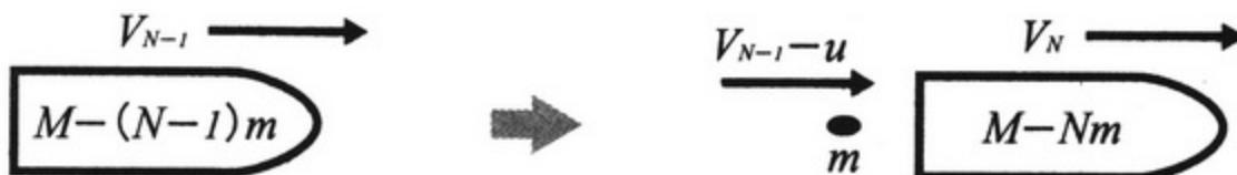
(以速度  $V_{N-1}$  为的火箭为参照物，小物体以速度  $-u$  从后面被放出去)
